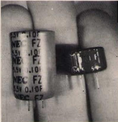
Figura 4. Due supercondensatori da 0,1 F.
